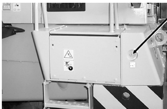
Рис. 4.13. Главный выключатель системы электрооборудования
