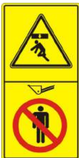
2. - Табличка безопасности – стрела (с обеих сторон машины)
