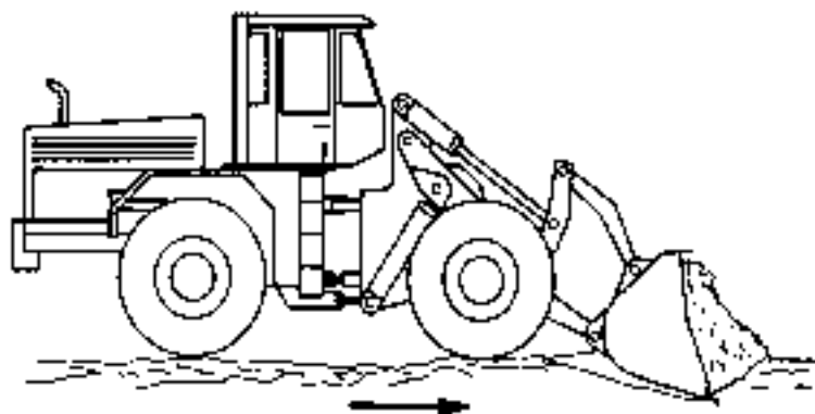
Рис. 4.38. Выемка материалов и отрывка котлованов
