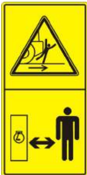
3. - Табличка безопасности – наезд (с обеих сторон машины)
