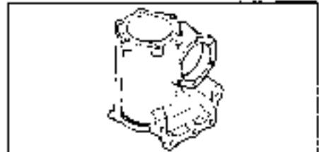
Осмотрите корпус и убедитесь в отсутствии трещин на корпусе и отсутствии царапин на поверхности, по которой перемещается поршень.
