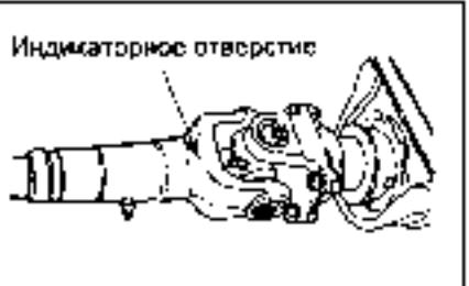
При помощи смазочного шприца нагнетайте через пресс-масленку смазку в соединение, пока оно не появится в индикаторном отверстии, показанном на рисунке. Закройте индикаторное отверстие пальцем и продолжайте нагнетать смазку, пока она не появится из под уплотнения скользящей вилки.
