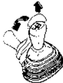
**Примечание:** если двигатель работает без сложить рычаг переключения МКПП невозможно.
