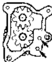
д) Установите масляный насос на блок цилиндров и затяните болты крепления номинальным моментом затяжки
