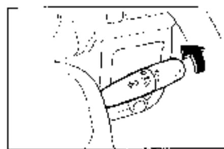
2 Для включения дальнего света фар нажмите на переключатель от себя, когда ручка переключателя находится в положении "ON2". Работа фар дальнего света сопровождается высвечиванием на комбинации приборов соответствующего индикатора.
