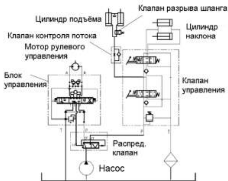
Рис. 9-1. Принцип работы гидравлической системы
