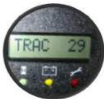
Рис. 8-11. Отображение неисправности на дисплее Curtis 840
