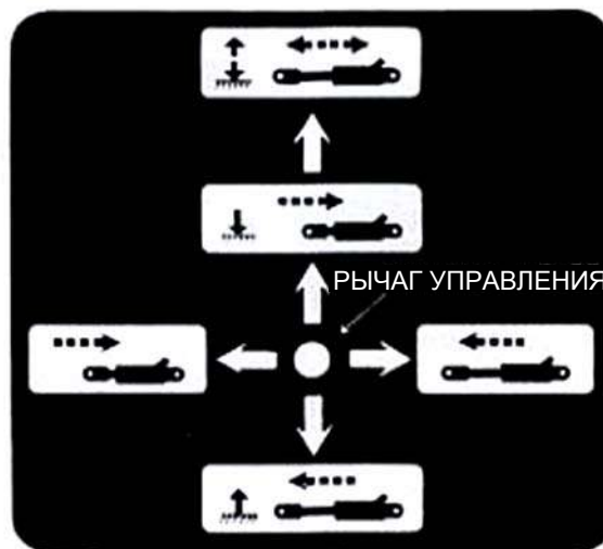
Рис. 42. Работа двухкаскадного клапана управления
