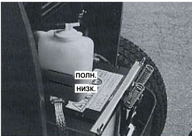
Рис. 59. Резервуар с охлаждающей жидкостью
