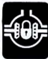
Блокировка дифференциала КОД – 390191690 РАСПОЛОЖЕНИЕ – Над педалью под сиденьем
