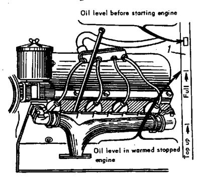
FIG.5. CHECK MARKS ON OIL LEVEL DIPSTICK 1
