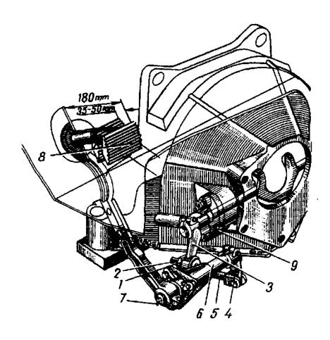
FIG.39. CLUTCH CONTROL LINKAGE
