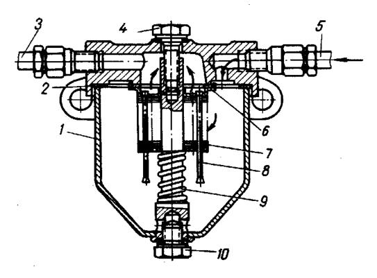
FIG. 10. FUEL FILTER-SETTLER
