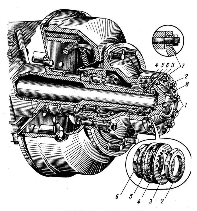
FIG.57. REAR WHEEL HUB OF ЗИЛ-130 TRUCK
