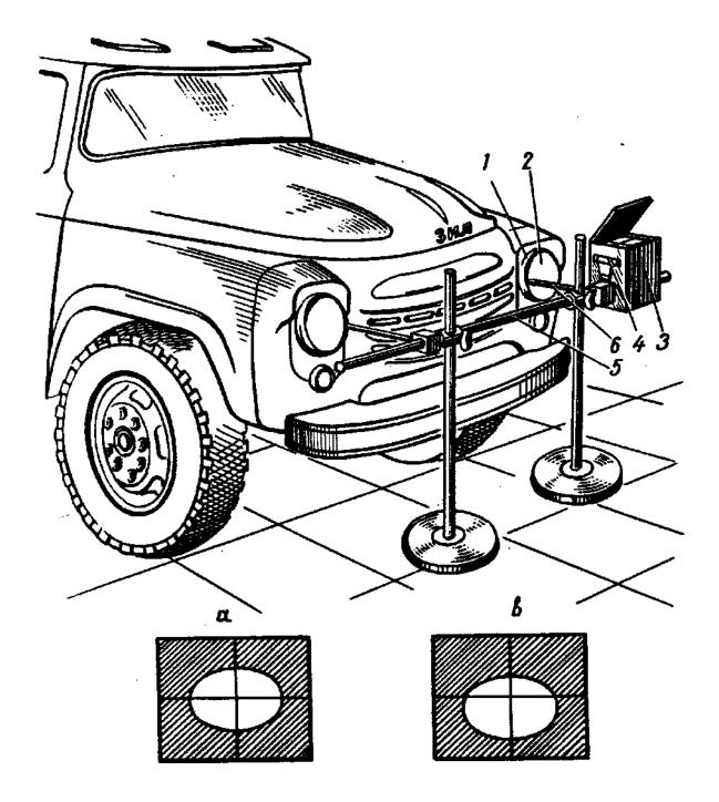
FIG.47. HEAD LAMP AIMING
