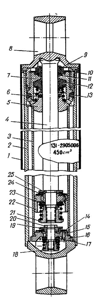
FIG.53. FRONT SUSPENSION SHOCK ABSORBER
