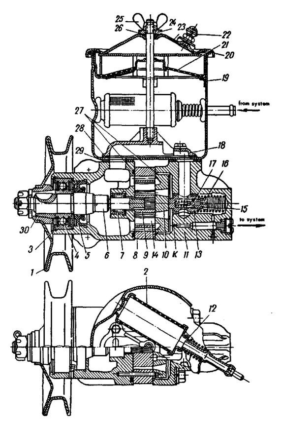
FIG.29. STEERING BOOSTER PUMP
