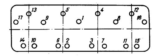
FIG.9. SEQUENCE OF TIGHTENING CYLINDER HEAD BOLTS
