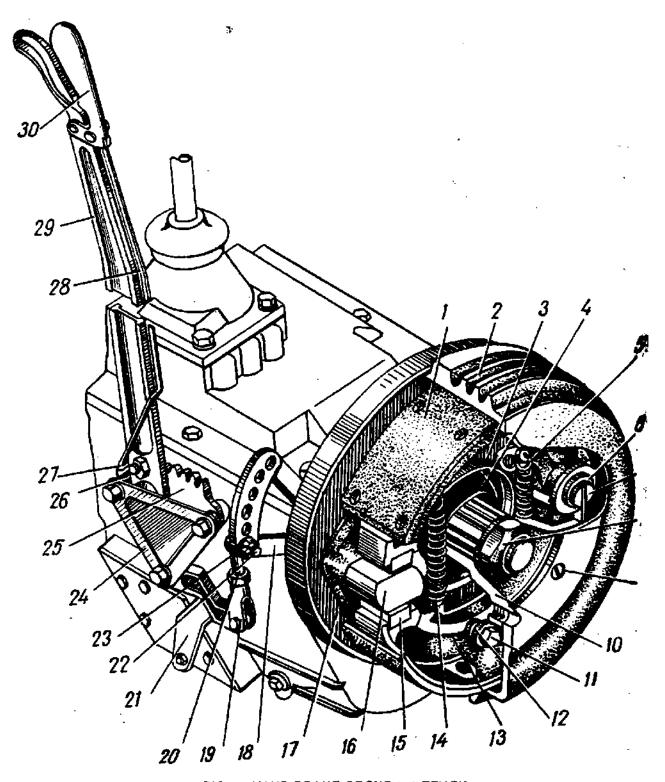
FIG.42. HAND BRAKE OF ЗИЛ-130 TRUCK
