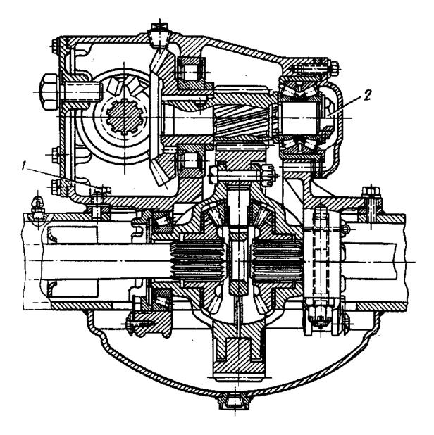
FIG.26. AXLE DRIVE OF ЗИЛ-131 TRUCK
