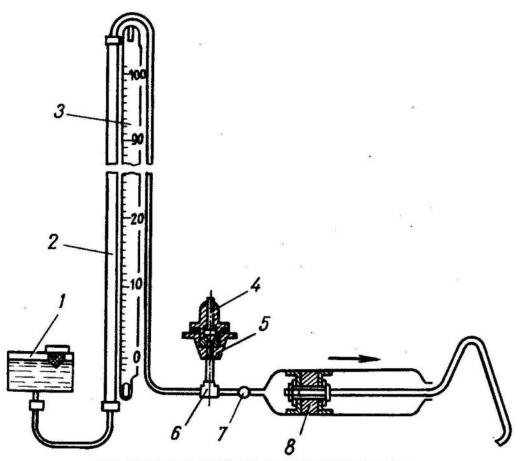
FIG. 61. NEEDLE VALVE AIRTIGHTNESS TESTER
