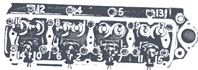
Fig 01A-11L 02 Orden de apriete de los tornillos de la culata
