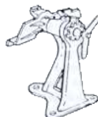
Fig 01A-09-02 – Soporte motor completo. Útil TTr/D 6005
