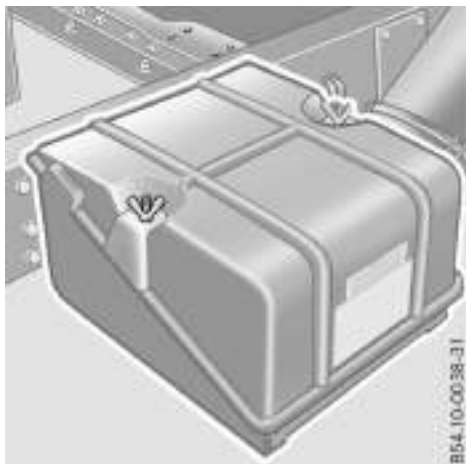
Localização das baterias
