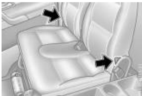
Alavanca da trava dos encostos do banco (setas)
