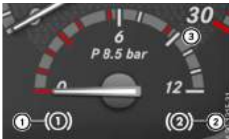
Indicador de pressão do ar comprimido (painel INS20 14)
