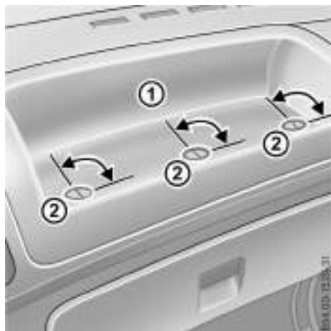
Acesso à caixa de fusíveis
